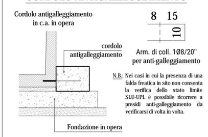
\* Prevedere uno scavo maggiorato di una misura non inferiore a 0,5m e non superiore ad 1m per ogni lato della vasca ed eseguire il reinterro con ghiaia di pezzatura 40/60mm
